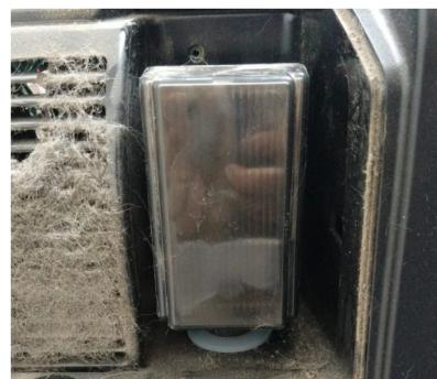
Claramente, podemos observar que el concentrador se encuentra en malas condiciones y al estar en esta situación, no se permite un buen funcionamiento del equipo. El suministro de oxígeno no se lleva a cabo como debe de ser y puede producir fallas en general.
