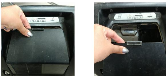
Presione y estire hacia usted, la tapadera también puede retirarse del equipo para que facilite el acceso y se pueda limpiar el área con facilidad. Podrá observar el filtro del concentrador:
